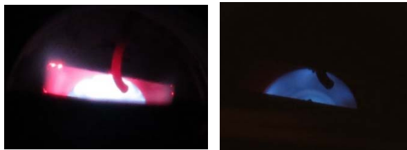
شکل ۷) سمت راست: نشان‌دهنده خروجی محفظه در حالت کاری مطلوب (داخل محدوده پایداری)، سمت چپ: نشان‌دهنده خروجی محفظه در حالت فراتر از حد بالای محفظه
