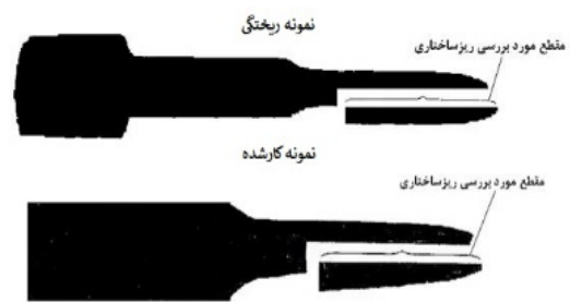
شکل ۳) نحوه برش کاری نمونه پس از آزمایش کشش گرم جهت بررسی ریزساختار
