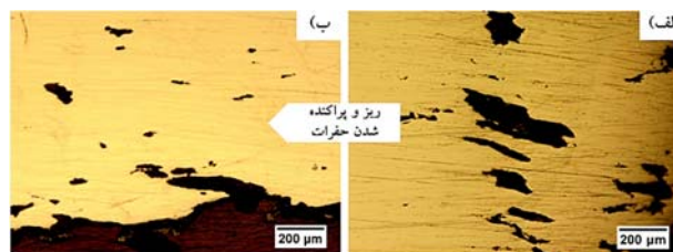
شکل ۱۰ مقایسه توزیع حفرات نمونه‌های فولاد W360 پس از آزمایش کشش گرم در نرخ کرنش ۰/۱ بر ثانیه و دمای ۲۰۰درجه سانتی‌گراد در شرایط الف) ریختگی، ب) کار شده
