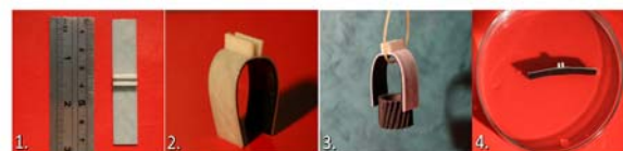
شکل ۷) نمونه‌ای از عملگر ساخته‌شده به روش لایه‌ای و کاربرد آن، ۱) شکل اولیه، ۲) ایجاد شکل ثانویه، ۳) حمل وزنه ۱۵ گرم، ۴) بازیابی به شکل اولیه
