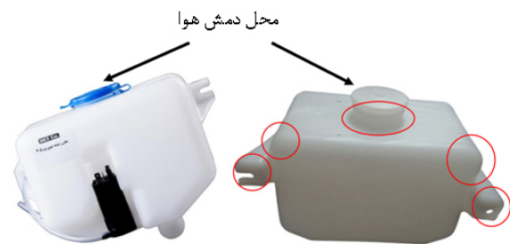
شکل ۱ مجموعه مخزن شیشه‌شوی پژو ۴۰۵
