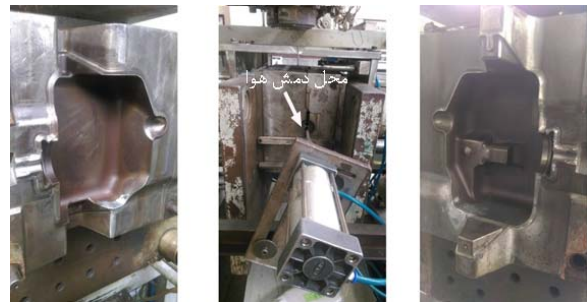
شکل ۴) دو نیمه قالب و مجموعه مونتاژ شده قالب
