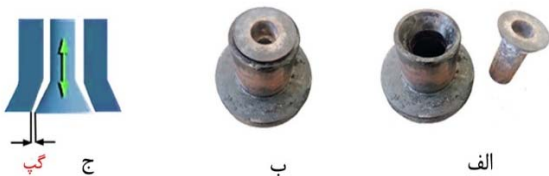
شکل ۲ (الف) دای واگرا و ماندل، (ب) دای و ماندل مونتاژشده، (ج) شماتیکی از تغییر دادن گپ دای
