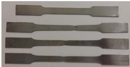
شکل ۲) نمونه‌های استاندارد کشش قبل و بعد از آزمون
