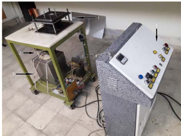
شکل ۵) دستگاه شکل‌دهی الکترومغناطیسی استفاده شده در آزمون تجربی؛ ۱- قالب و سیم‌پیچ، ۲- بانک خازن، ۳- سوئیچ، ۴- منبع تغذیه، ۵- قسمت کنترل
