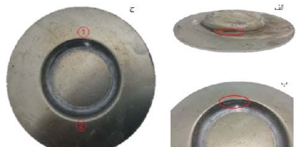
شکل ۱۲) الف) پارگی زودرس مشاهده شده در ناحیه نزدیک به فلنج در سطح خارجی ورق، ب) پارگی در ناحیه نزدیک به فلنج در سطح داخلی ورق، ج) کشیدگی ورق به یک سمت و بروز پارگی در ناحیه شماره ۱ (آزمون در زاویه دیواره ۶۰ درجه، دمای ۴۰۰ درجه سانتی‌گراد، گام عمودی ۰/۶ میلی‌متر، سرعت پیش‌روی ۶۰۰ میلی‌متر بر دقیقه و در حضور روانکار گرافیت صورت گرفته است)
