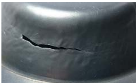
شکل ۸) اعوجاج ناشی از پیچش در ورق (آزمون در زاویه دیواره ۶۰ درجه، دمای ۴۰۰ درجه سانتی‌گراد، گام عمودی ۰/۶ میلی‌متر، سرعت پیش‌روی ۶۰۰ میلی‌متر بر دقیقه و بدون روانکار صورت گرفته است)
