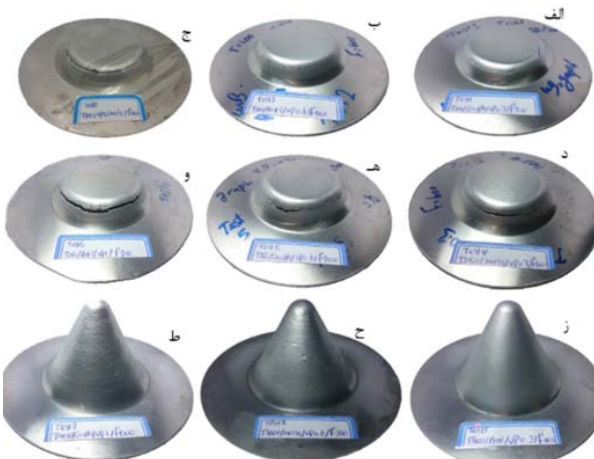
شکل ۱۳) قطعات شکل‌داده شده در طراحی آزمایش تاگوچی مطابق جدول ۴ برای: الف) آزمون ۱، ب) آزمون ۲، ج) آزمون ۳، د) آزمون ۴، ه) آزمون ۵، و آزمون ۶، ز) آزمون ۷، ح) آزمون ۸، ط) آزمون ۹
