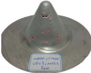
شکل ۱۸) عیوب مختلف مشاهده شده در شکل‌دهی ورق در زاویه ۶۰ درجه، دمای ۴۰۰ درجه سانتی‌گراد، گام عمودی ۰/۳ میلی‌متر، سرعت پیش‌روی ۰/۶ میلی‌متر بر دقیقه با استفاده از روانکار مولیبدن‌دی‌سولفید
