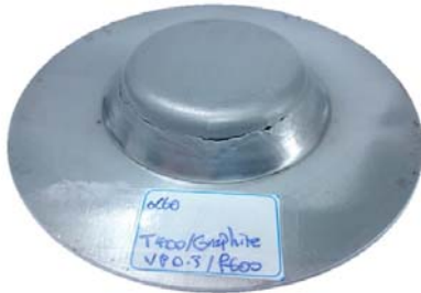
شکل ۱۷) نمونه شکل‌داده‌شده در زاویه ۶۰ درجه، دمای ۴۰۰ درجه سانتی‌گراد، سرعت پیش‌روی ۰/۶ میلی‌متر بر دقیقه، با استفاده از روانکار پودر گرافیت در گام عمودی ۰/۳ میلی‌متر
