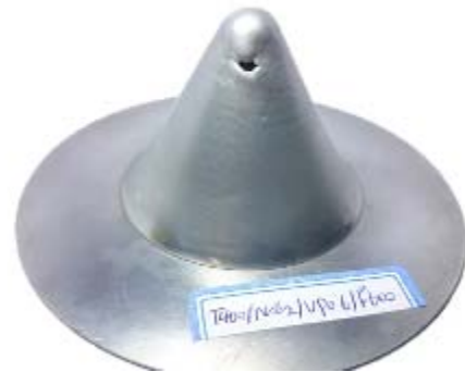
شکل ۱۱) ترک پایدار مشاهده شده در سطح داخلی و بیرونی قطعه (آزمون در زاویه دیواره ۶۰ درجه، دمای ۴۰۰ درجه سانتی‌گراد، گام عمودی ۰/۶ میلی‌متر، سرعت پیش‌روی ۶۰۰ میلی‌متر بر دقیقه و در حضور روانکار گرافیت صورت گرفته است)
