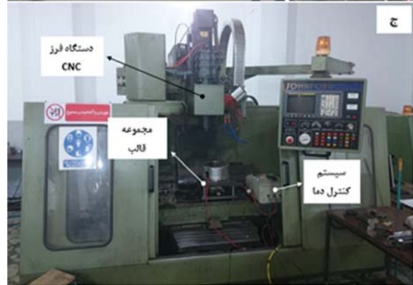
شکل ۳ الف) مجموعه قالب، ب) نمایشگر کنترلر دمایی مربوط به هر المنت سوار بر مدار کنترل دما، ج) دستگاه فرز CNC
