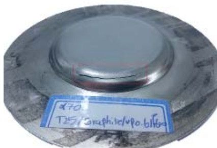
شکل ۹) ترک پیش‌رونده پدیدار شده در سطح قطعه (آزمون در زاویه دیواره ۷۰ درجه، دمای ۲۵۰ درجه سانتی‌گراد، گام عمودی ۰/۶ میلی‌متر، سرعت پیش‌روی ۶۰۰ میلی‌متر بر دقیقه و در حضور روانکار گرافیت صورت گرفته است)
