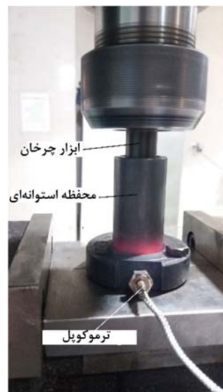
شکل ۳) قسمت‌های مختلف قالب فرآیند فشرده‌سازی برشی
