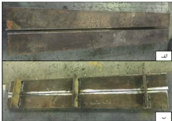
شکل ۲) نمای کلی از قطعه ساخته‌شده قبل از جوشکاری؛ الف) نمای بالا پس از پخزنی، ب) پشت قطعه و پشت‌بندها
