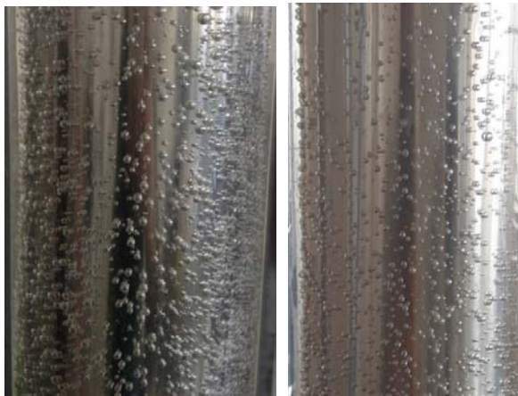
شکل ۴) اثر افزایش شار حرارتی بر رفتار حباب روی سطح در جوشش مادون سرد در دبی جرمی 0.02 \text{ kg/s} و دمای مادون سرد ورودی 50^\circ\text{C}
