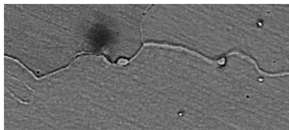
شکل ۹) جوشکاری دو ورق فولادی با پرتابه کرومی ( t=3\text{mm} , SD=0.2\text{mm} )
