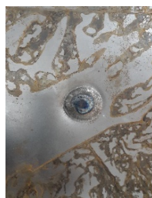
شکل ۳) جوشکاری دو ورق فولادی با پرتابه کروی (t=3mm, SD=0.1mm)
