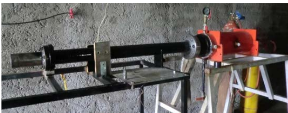
شکل ۱) تصویر سامانه انفجار مخلوط گازها
