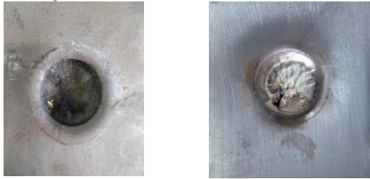
شکل ۶) جوشکاری دو ورق فولادی با پرتابه مسطح (t=2mm, SD=0.1mm)
