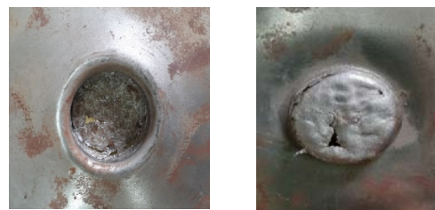
شکل ۸) جوشکاری دو ورق فولادی با پرتابه مسطح (t=1mm, SD=0.1mm)
