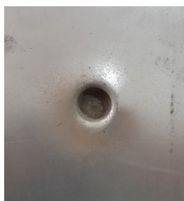
شکل ۳) جوشکاری دو ورق فولادی با پرتابه کروی (t=3mm, SD=0.1mm)
