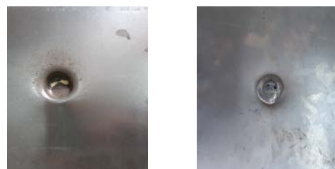
شکل ۹) جوشکاری دو ورق فولادی با پرتابه کرومی (t=1mm, SD=0.1mm)
