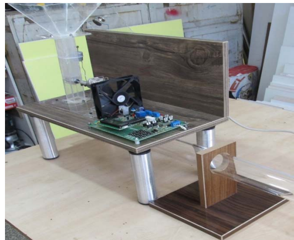
شکل ۳) نمایی از بخش نگهداری، بخش توزیع ذرات جامد و موتور درایور دیجیتال DC در سامانه آزمایشگاهی ساخته‌شده
