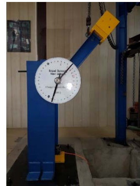
شکل (۴) تصویر دستگاه ضربه شاری ساخته‌شده در آزمایشگاه ضربه دانشگاه بیرجند
