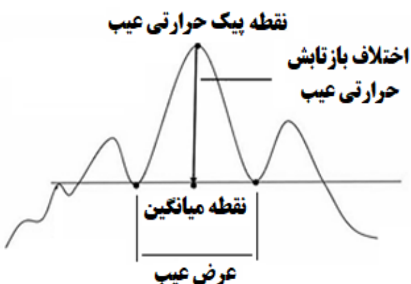
شکل ۵) نحوه محاسبه دقت اندازه‌گیری و اختلاف حرارتی عیوب
