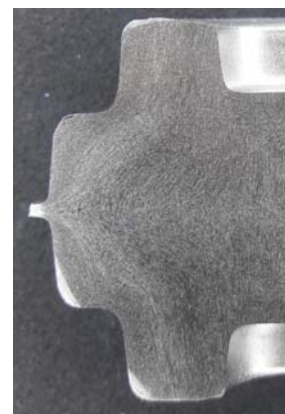
شکل ۱۱) نمایش نحوه سیلان مواد در آهنگری داغ همدمای آلومینیوم ۶۰۶۱
