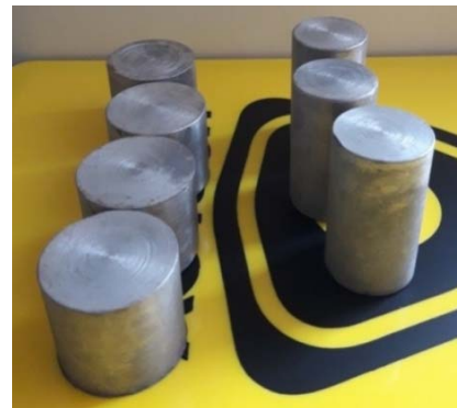
شکل ۶) آماده سازی شمش های اولیه با قطرهای ۳۵ و ۲۸ میلی متر جهت انجام آهنگری همدمای
