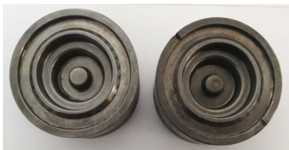
شکل ۴) نیمه بالا و نیمه پایین قالب آهنگری ساخته شده
