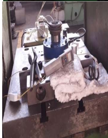
شکل ۵) دستگاه پرس هیدرولیک ۶۳ تن مورد استفاده جهت آهنگری و موقیعت سنسور وزن، قالب و تجهیزات گرمایشی مورد استفاده بر میز دستگاه
