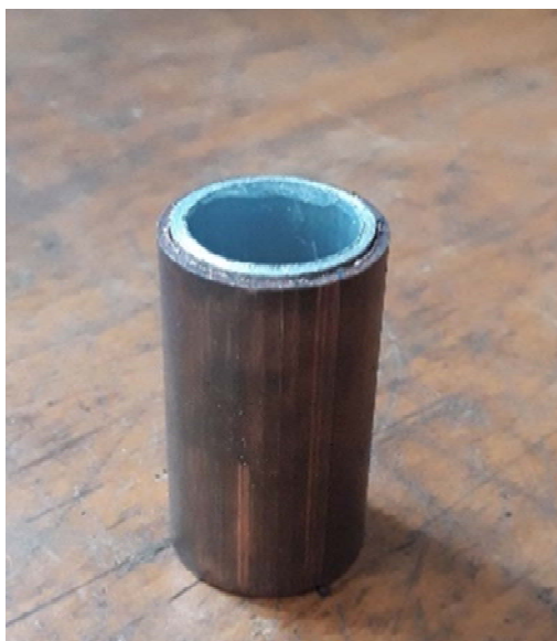
شکل ۱) لوله دولایه پرس‌شده پیش از انجام فرآیند اکستروژن مستقیم
