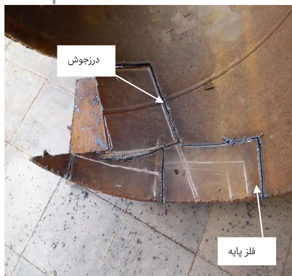
شکل ۵) موقعیت و جهت نمونه آزمایش خمش سه نقطه‌ای: (a) درزجوش، (b) فلز پایه در لوله واقعی با درزجوش ماریچ [17]
