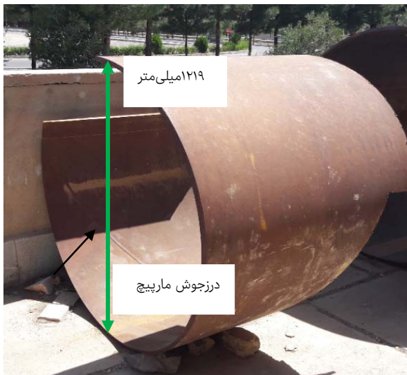
شکل ۲) لوله درز جوش مارپیچ فولادی جهت استخراج نمونه‌های آزمایشگاهی
