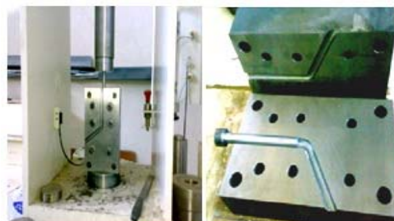
شکل (۳) قالب ECAP و پرس استفاده شده
