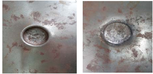
شکل ۲ جوش کاری دو ورق فولادی با پرتابه مسطح (ضخامت صفحه پرنده ۳ و فاصله بین دو ورق ۱/۰ میلی‌متر)
