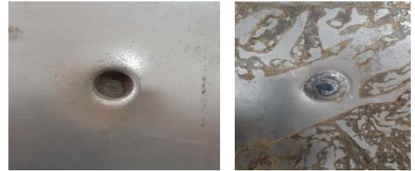
شکل ۳ جوش کاری دو ورق فولادی با پرتابه کروی (ضخامت صفحه پرنده ۳ و فاصله بین دو ورق ۱/۰ میلی‌متر)
