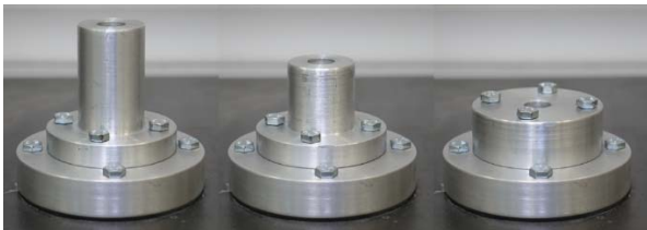
شکل ۴) تصویر سه نازل مورد استفاده به ترتیب به افزایش نسبت فاصله درنگ (از راست به چپ)
