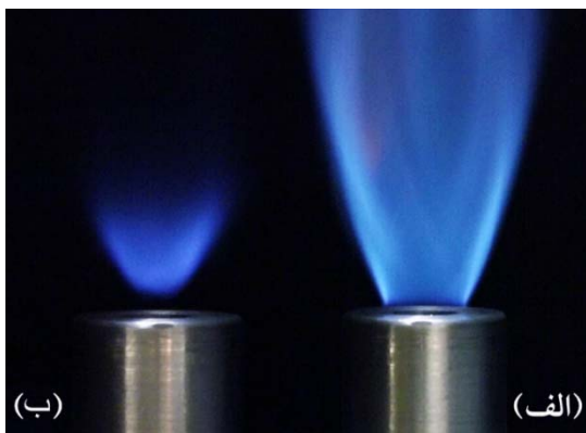
شکل ۵ (الف) شعله متصل به دهانه نازل مشعل، (ب) شعله معلق پایدار
