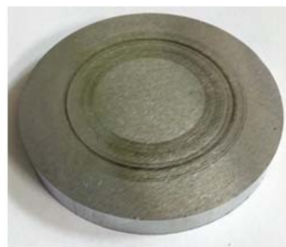
شکل ۴) دیسک تهیه‌شده از جنس ST37
