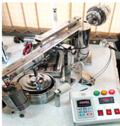
شکل ۳) دستگاه آزمون پین روی دیسک دانشکده مهندسی مکانیک دانشگاه صنعتی اصفهان
