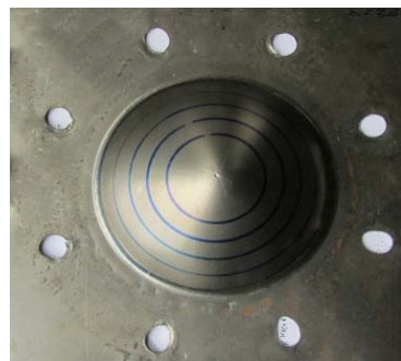
شکل ۲) نمونه‌ای از ورق‌های فولادی تغییر شکل یافته؛ (الف) شکل‌دهی آزاد، (ب) شکل‌دهی با قالب
