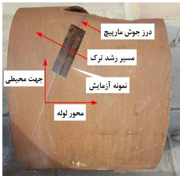
شکل ۷) لوله API X65 با درجوش مارپیچ و نمونه آزمایشگاهی جدا شده از آن
