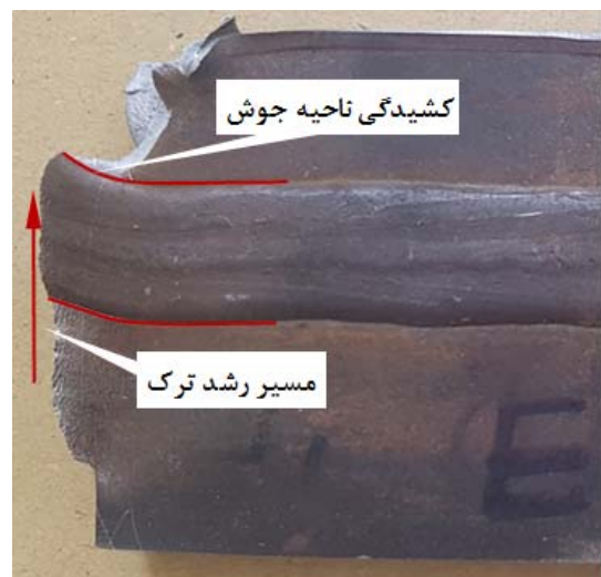
شکل ۱۶ کشیدگی ناحیه جوش به سمت انتهای مسیر شکست
