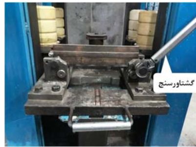
شکل ۱۱) بستن نمونه آزمایش در گیره دستگاه با کمک گشتاورسنج
