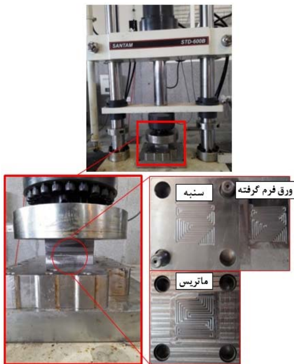
شکل ۲) نمایی از پرس هیدرولیکی و مجموعه قالب سوار شده بر روی آن
