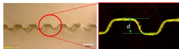
شکل (۵) پروفیل پرشدگی صفحه دوقطبی شکل‌دهی شده و تعیین درصد پرشدگی و برگشت فنری (D برابر با ۷۰/۰ و d برابر با ۰/۶۳ میلی‌متر، مقدار پرشدگی ۹۷٪)
