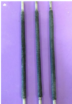
شکل ۲) ستون‌های آلومینیومی تقویت شده با کمر بند کامپوزیتی حاوی نانولوله‌های کربنی
