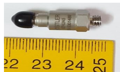
شکل ۷) شتاب‌سنج کیستلر نصب شده روی چکش دستگاه
