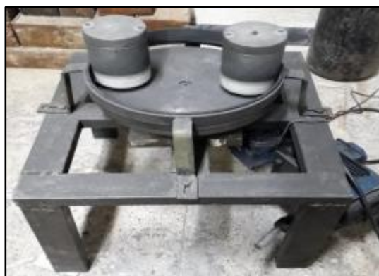
شکل ۲) آسیای گلوله‌ای سیاره‌ای با انرژی بالا مورد استفاده در فرایند آسیای مکانیکی
