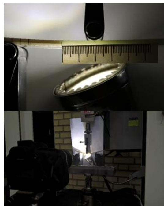
شکل ۴ تجهیزات آزمایشگاهی و تنظیم دستگاه جهت انجام آزمایش شکست
