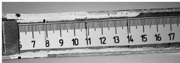
شکل ۵) رشد تورق در ناحیه اتصال پوسته به هسته و متناظر با ناحیه (۱) تا (۲) در نمودار بار-جابجایی
