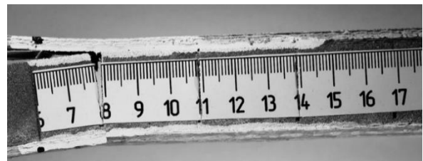
شکل ۶) رشد ترک در فوم و شکست بلوک اول فوم و متناظر با ناحیه (۳) تا (۴) در منحنی بار-جابجایی
