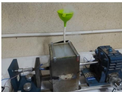
شکل ۷ محفظه دماهای منفی و کانال اضافه کردن نیتروژن
