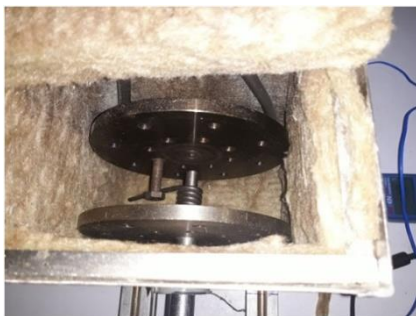
شکل ۶ نمای داخل کوره و عایق بندی آن
