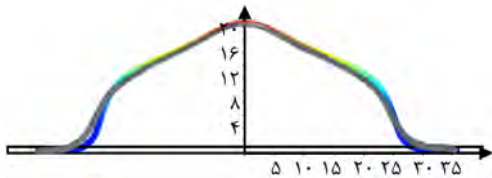
شکل ۲۵) مقایسه پروفیل قطعه شکل‌دهی شده و شبیه‌سازی در ولتاژ ۷۳۴۰۰
