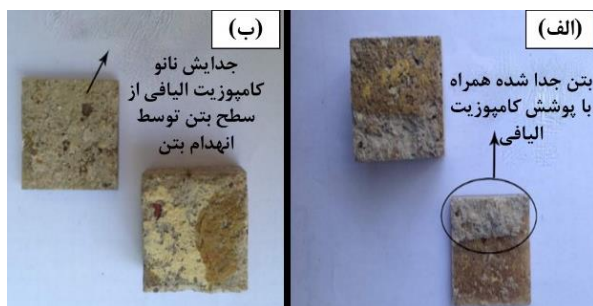
شکل ۱۳) سطح نمونه‌های بتن بعد از آزمون چسبندگی برشی، الف) کامپوزیت الیافی ب) نانو کامپوزیت الیافی
