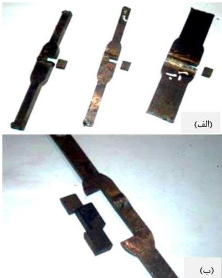
شکل ۳ الف- نمونه‌های برش کاری توسط وایبرکات برای متالوگرافی ب- نمونه‌های برش کاری شده توسط وایبرکات برای آزمون ریزسختی سنجی
