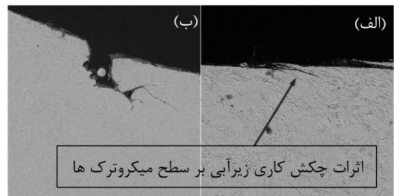
شکل ۱۰) (الف) تصاویر تأثیر چکش کاری در زیر آب بر روی ترک سطحی
