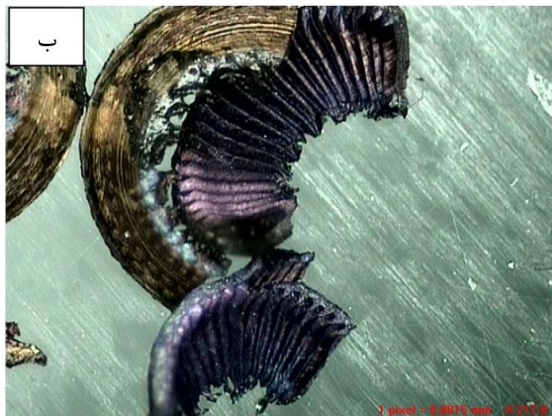
شکل ۱۳) براده حاصل از ماشین کاری الف) خشک و ب) برودتی فولاد زنگ‌زن AISI 440C با نرخ پیشروی ۰/۱۸ میلی‌متر بر دور
