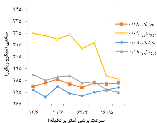
شکل ۹) نتایج میکروسختی‌سنجی فولاد زنگ‌نزن AISI 440C پس از ماشین‌کاری برای ۸ سرعت برشی مختلف و با نرخ پیشروی ۰/۰۹ و ۰/۱۸ میلی‌متر بر دور
