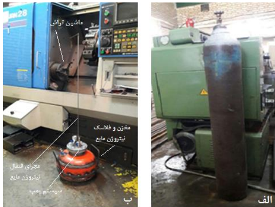
شکل ۳ (الف) کیسول هوا جهت تامین فشار هوای مورد نیاز در پمپ نیتروژن در فشارهای بالاتر از ۸ بار (ب) دستگاه تراش CNC مجهز به مخزن و پمپ نیتروژن مایع
