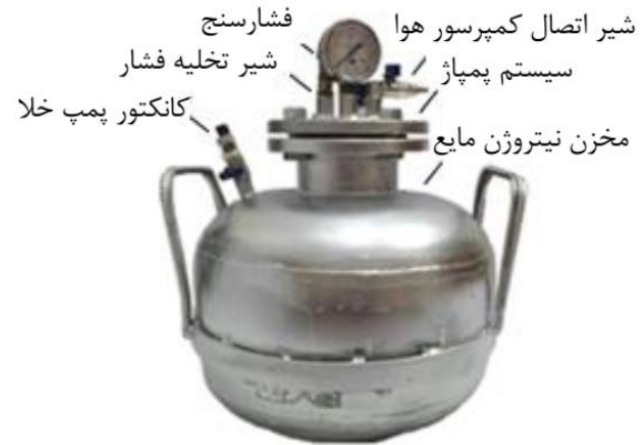
شکل ۱ فلاسک ساخته شده در تحقیق حاضر مخصوص نگهداری نیتروژن مایع مجهز به مانومتر فشار
