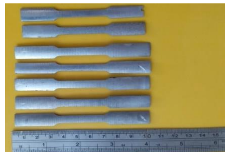
شکل ۹ برخی نمونه‌های آزمایش کشش برش داده‌شده از لوله فلوفرم شده
