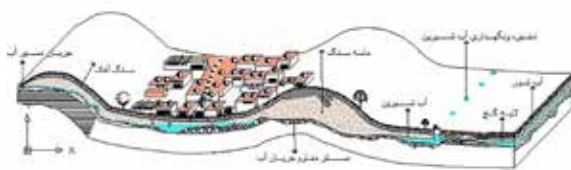
تصویر شماره ۸: طرح شماتیک از نحوه ذخیره و نگهداری آب؛ ماخذ: نگارندگان
