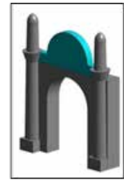
وجود ناجی به شکل نیم وجود دو منون در طرفین درگاه ورودی در اغلب اینگونه دروازه‌ها.
