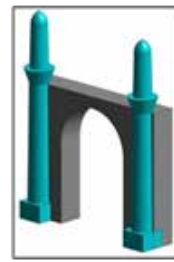
وجود ناجی به شکل نیم وجود دو منون در طرفین درگاه ورودی در اغلب اینگونه دروازه‌ها.
