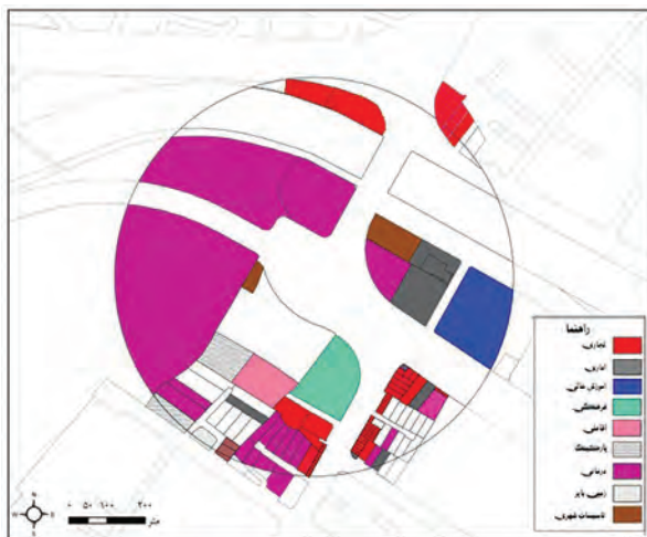
تصویر ۷- نقشه کاربری غیرمسکونی در ایستگاه نمازی
