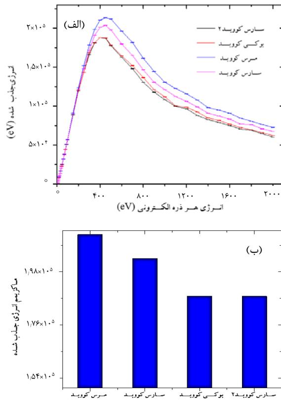
شکل ۸. (الف) انرژی جذب شده برای اسپایک‌های مختلف بر حسب انرژی هر ذره الکترون تابیده شده توسط منبع را نشان می‌دهد. در این شکل میله‌های خطانیز برای هر گام انرژی ترسیم شده است که به دلیل میزان کم خطان نسبت به مقدار انرژی جذب شده، ارتفاع میله‌های خطان به طور ناچیز دیده می‌شود. (ب) نمودار میله‌ای ماکسیمم انرژی جذب شده توسط هر یک اسپایک‌ها را نشان می‌دهد.
