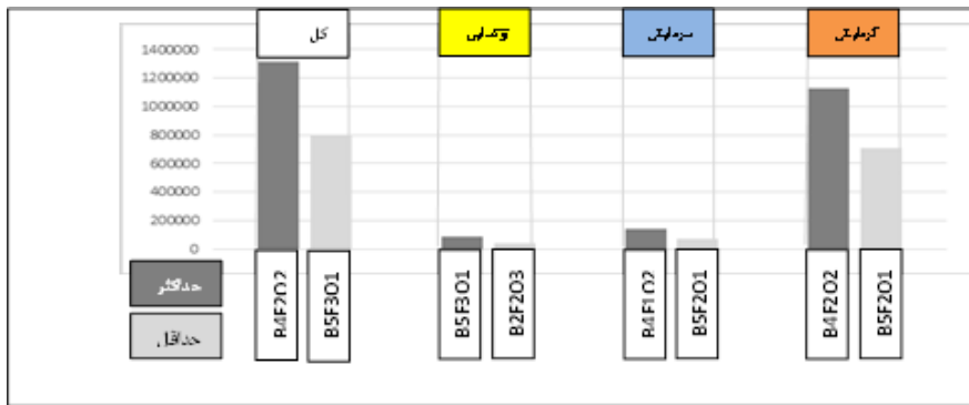
شکل ۸- نتایج شبیه‌سازی حداکثر و حداقل مصرف انرژی کل (گرمایش، سرمایش و روشنایی) به ازای کیلووات ساعت بر مترمربع
