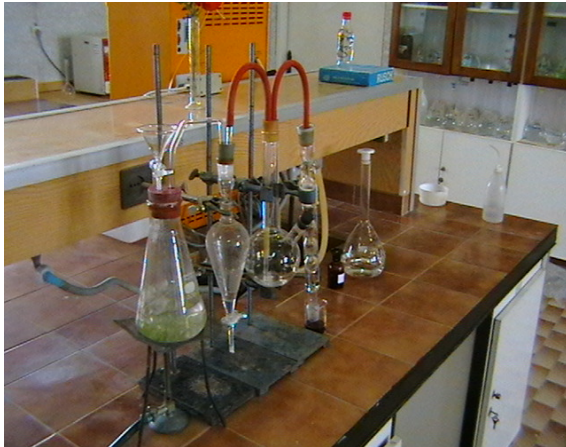
تصویر ۳: اندازه گیری کیفیت پروتئین علوفه مصرفی با روش کجدال
