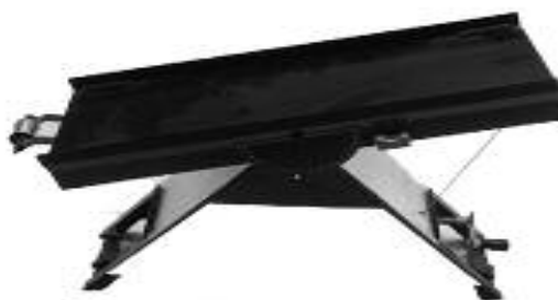
شکل ۲- دستگاه اندازه گیری ضرایب اصطکاک ایستایی.
