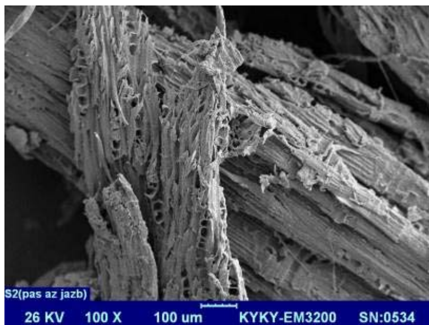
شکل ۱۱: عکس میکروسکوپ الکترونی روبشی بعد از جذب فلز توسط خاکاره درخت کنار با بزرگنمایی ۱۰۰X.
