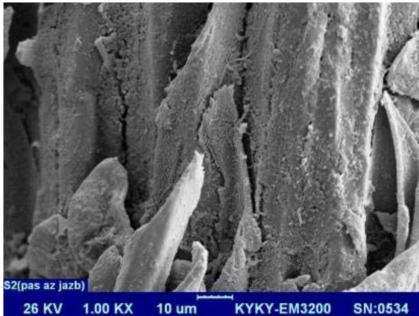
شکل ۱۲: عکس میکروسکوپ الکترونی روبشی بعد از جذب فلز توسط خاکاره درخت کنار با بزرگنمایی ۱KX.
