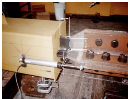
شکل ۳، نمایش قسمت محصور نشده هسته فولادی [۴]
