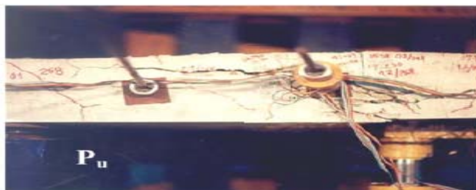
شکل ۱۲- مسیر ترک مورب در بار نهایی در مقطع عرضی نمونه تحلیلی S_3 و نمونه آزمایشگاهی [۳]
