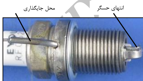
شکل ۶- حسگر دمای نصب شده روی الکتروود منفی
