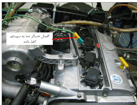
شکل ۹- اتصال موتور و حسگر دما به سامانه خوانش داده
