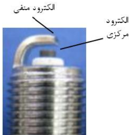
شکل ۳- شکل دهانه شمع‌های مورد استفاده در آزمون‌ها
