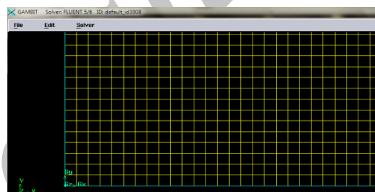
شکل ۴- نمونه مش بندی در نرم افزار Gambit
