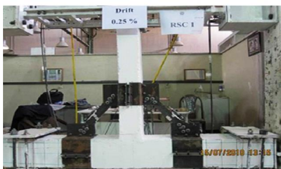
شکل ۲- نمای دوبعدی، سه بعدی و تصویر مدل آزمایشگاهی نحوه بکارگیری طوقه و دستک [۱۳]
