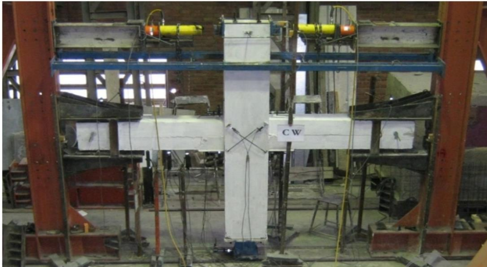
شکل ۱ - نمونه آزمایشگاهی اتصال مورد مطالعه [5]
