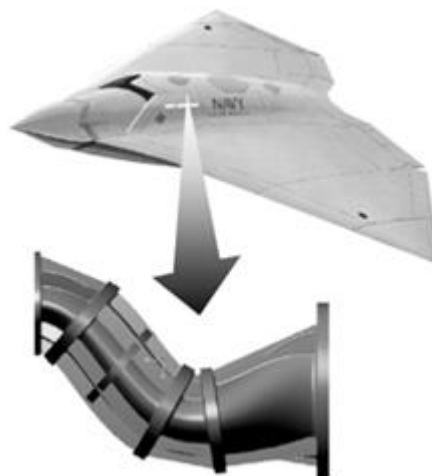
شکل ۱- کانال مارپیچی دو پیچشه در یک پهباد رزمی [۱]
